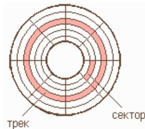
Рис. 3. Поверхность магнитного диска
